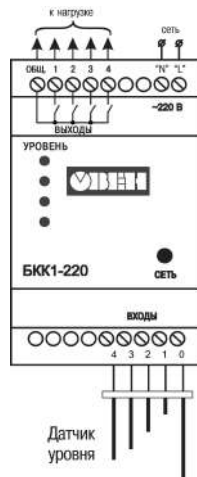
Рисунок 5.4 – Схема подключения БКК1-220
