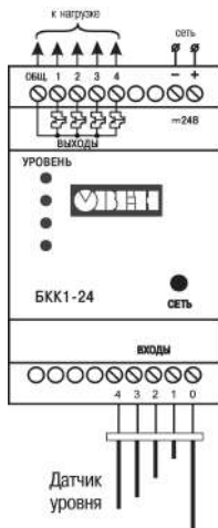
Рисунок 5.3 – Схема подключения БКК1-24
